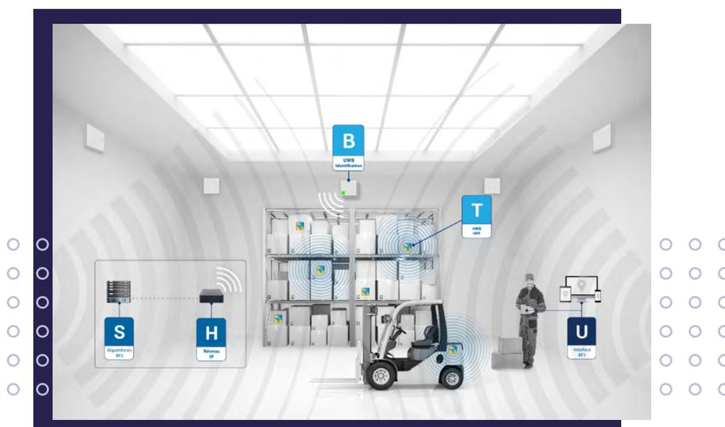
Système UWINLOC composé d'une infrastructure de balises de détection UWB, de sources d'énergie de télé-alimentation, d'étiquettes passives sans batterie attachées à des objets client et de la plateforme de visualisation des données.
