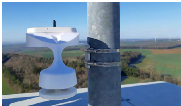
Windfit box équipant une éolienne de 3 MW
